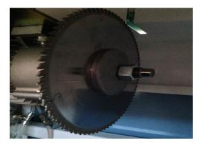
Le système de blocage du profilé agit avant le mouvement de la lame afin de recouvrir complètement la partie tranchante exposée et de bloquer la pièce à découper. Système de commande avec pédalier contre les accidents du travail. Toutes les commandes au contact de l'opérateur sont en basse tension de sécurité. Protections contre l'accès aux parties dangereuses des machines conformément aux normes européennes.
