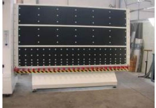
Optional Dispositif de basculement hydraulique
