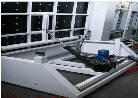
Optional dispositif de basculement hydraulique
