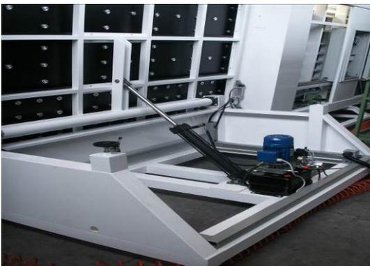
Optional dispositif de basculement hydraulique
