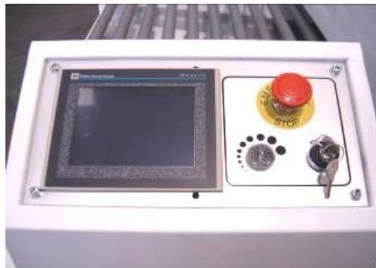
Pannello di controllo con **EASY TOUCH SYSTEM** un semplice schermo tattile che permette all'operatore di controllare il processo di lavorazione, regolare i tempi e controllare il singolo funzionamento di ogni componente. Tutti i comandi a contatto con l'operatore sono in bassa tensione di sicurezza con pannello luminoso a bordo macchina. Protezioni contro l'accesso alle parti pericolose della macchina secondo normative europee.
