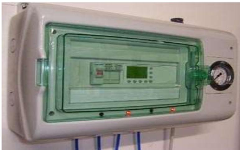
Macchina per riempimento gas nelle vetrate isolanti. Funzionamento volumetrico (a volume di riempimento) inserendo le tre misure del vetrocamera (altezza, larghezza, spessore) e premendo il pulsante del canale. Quattro canali separati per il riempimento contemporaneo di quattro vetrate. Massime misure di riempimento: 5,12 m. x 5,12 m. x 100 mm di camera. Il controllo avviene tramite PLC. Possibilità di modificare la velocità di riempimento. Avvisatore acustico di fine ciclo.
