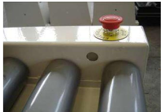
01 Salida motorizada de largo 2 mt que tiene una altura de 0,90 mt con rodillos anti-corte, ruedas dentadas montadas sobre cojinetes de material plástico especial, este módulo tiene un motor completo de reductor. Dos ventiladores de alta presión con cuatro sopladores, sistema de retención de vidrio utilizando un sensor. Protecciones contra el acceso a partes peligrosas de la máquina de acuerdo a las normas europeas
