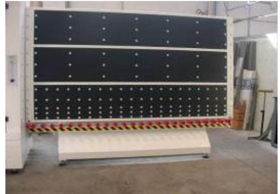
Optional salida con sistema hidráulico de inclinación
