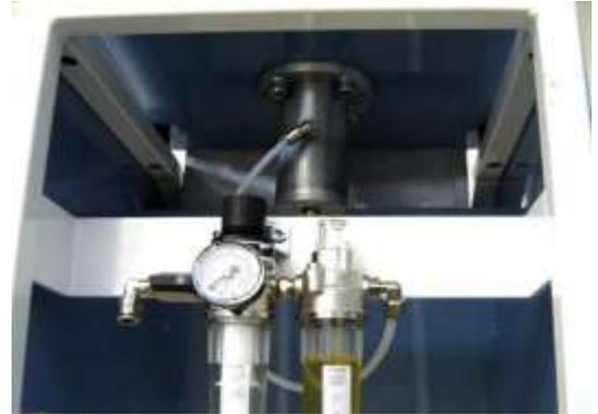
Controllo presenza aria nell'impianto pneumatico tramite manometro. Sistema di lubrificazione del motore pneumatico. Protezioni contro l'accesso alle parti pericolose della macchina secondo normative europee.
