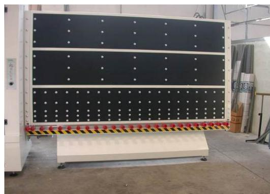
Optional salida con sistema hidráulico de inclinación
