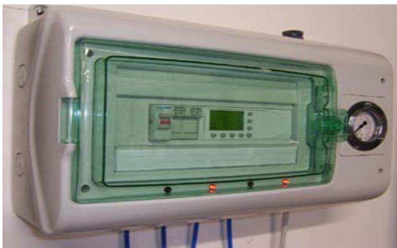
Máquina para el llenado de gas en unidades de vidrio aislante. Volumétrica de operación (llenado por volumen) mediante la inserción de las tres medidas de doble acristalamiento (alto, ancho, espesor) y pulsando el botón del canal. Cuatro canales separados para el llenado simultáneo de cuatro ventanas. Las medidas de resumen de llenado: 5,12 m. x 5,12 m. x 100 mm de la habitación. La unidad está controlada por el PLC. Posibilidad de cambiar la velocidad de llenado. Audible final del ciclo.
