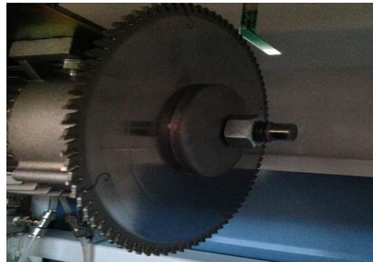
El sistema de bloqueo del perfil a cortar actúa antes de que el movimiento de la cuchilla de manera que cubra completamente la parte expuesta de corte y sujetar la pieza de trabajo a cortar. Sistema de control con pedales de prevención de accidentes. Todos los comandos están en contacto con el operador en baja tensión de seguridad.
