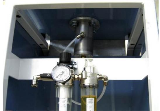
Compruebe si hay aire en el neumático a través del medidor. Sistema de lubricación del motor de aire. Protección contra el acceso a partes peligrosas de la máquina de acuerdo a las normas europeas.
